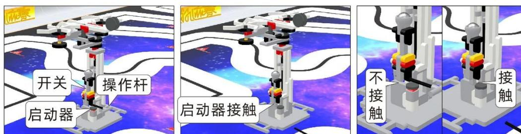
图 7 探测器启动的初始及完成状态
