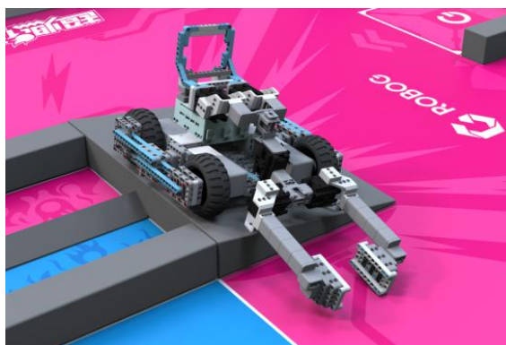
登上斜坡失败状态（与图纸接触）
