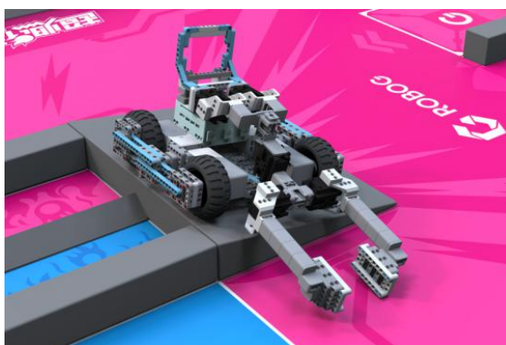
登上斜坡失败状态（与图纸接触）
