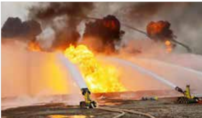
• 中倍数泡沫灭火机器人参与油罐区灭火救援
