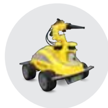
巡检灭火机器人
