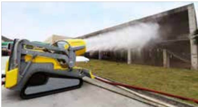
• 消防排烟灭火机器人排烟降尘
