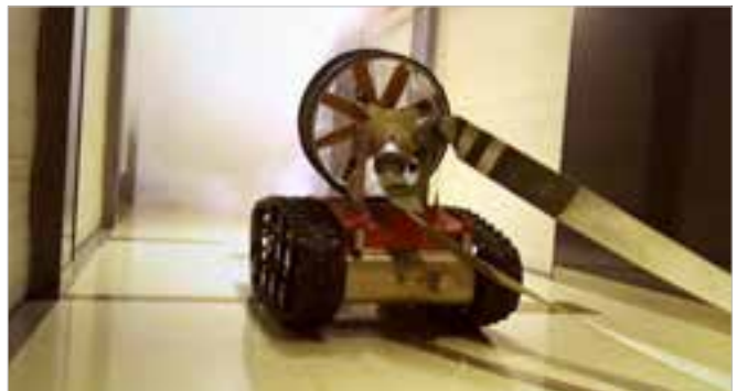
• 消防排烟机器人在大型商场执行排烟作业
