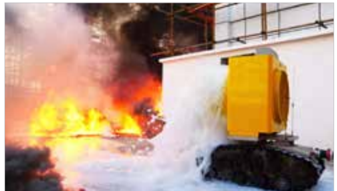
• 高倍数泡沫灭火机器人扑灭流淌火
