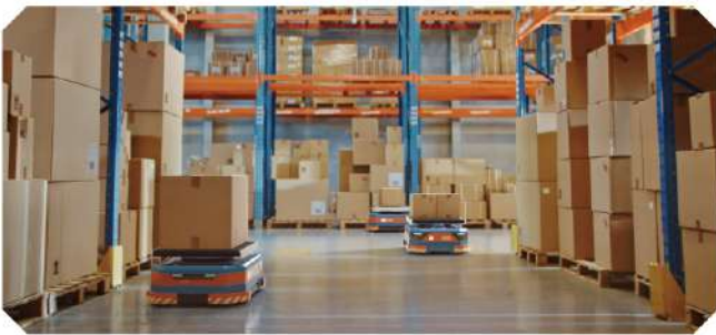
AGV 智慧物流：基于计划实现物料的无人精准配送
