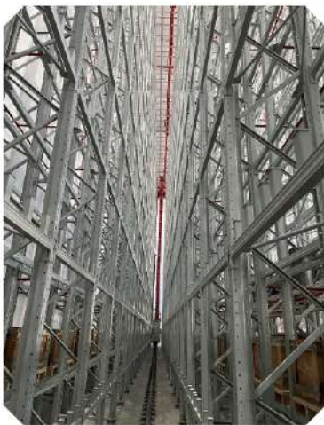
智能电子物料库 16500个货位，实现每天2万台电机生产用料需求
