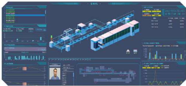
看板 实时展示生产现场状况，基于产线为单元的人、机、料、法、环的信息
