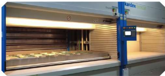
智能电子物料库 恒温恒湿环境，实现电子元件的精细化管理
