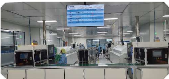
PCBA车间 1000级洁净度车间+自主研发FFU运行监控系统
