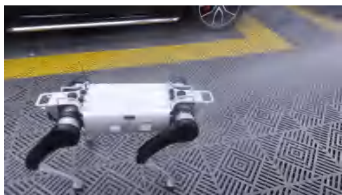
D30高压水枪喷水测试
