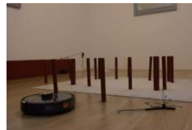
苏州大学相城机器人与智能装备研究院 基于扫地机器人"PoseTrackingSystem"的测量实验
