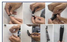
电机支架组装
