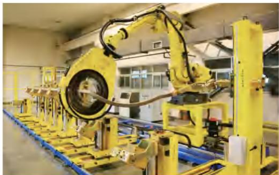
加拿大多功能包带机器人,用于发电机线棒的包扎。
