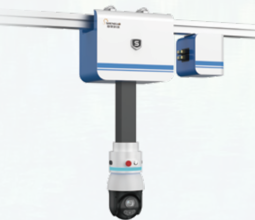
▲ 智能巡视机器人
