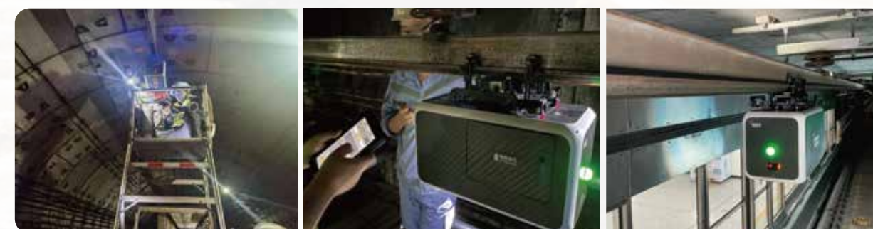
▲ 刚性接触网智能巡检机器人运用案例
