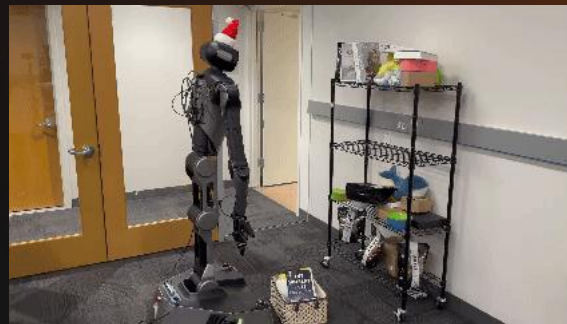
整理货架物品： 机器人在储藏室内从地面拾取箱子→移动到四层货架→（根据可用空间）将箱子放置在相应的货架层上
