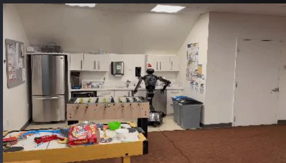
派对后清理房屋： 机器人按顺序完成从打开洗碗机门→整理桌面餐具→放置餐具进洗碗机→关闭洗碗机门
