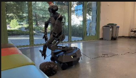
倒垃圾： 机器人从客厅拾取垃圾袋→导航至门口→开门→移动到室外垃圾桶
