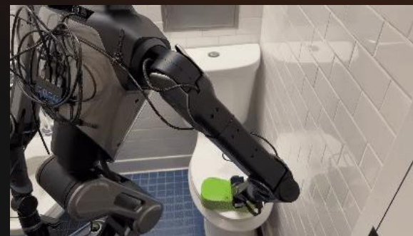
清洁马桶： 灵活调整躯干角度，开盖、擦拭、按压冲水按钮一气呵成
