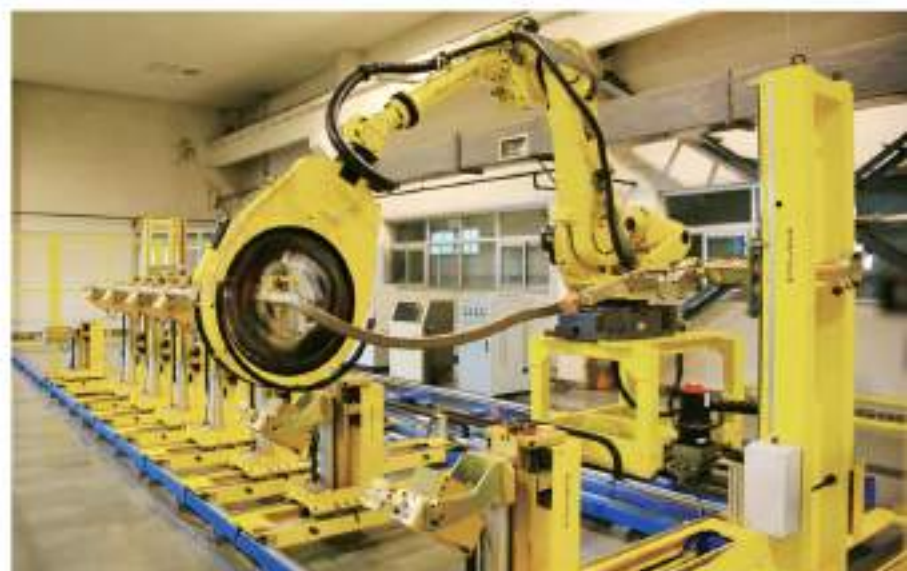
加拿大多功能包带机器人, 用于发电机线棒的包扎。 Canadian multifunctional taping robot, used for taping generator winding bars.
