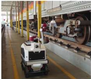
地铁巡检机器人
