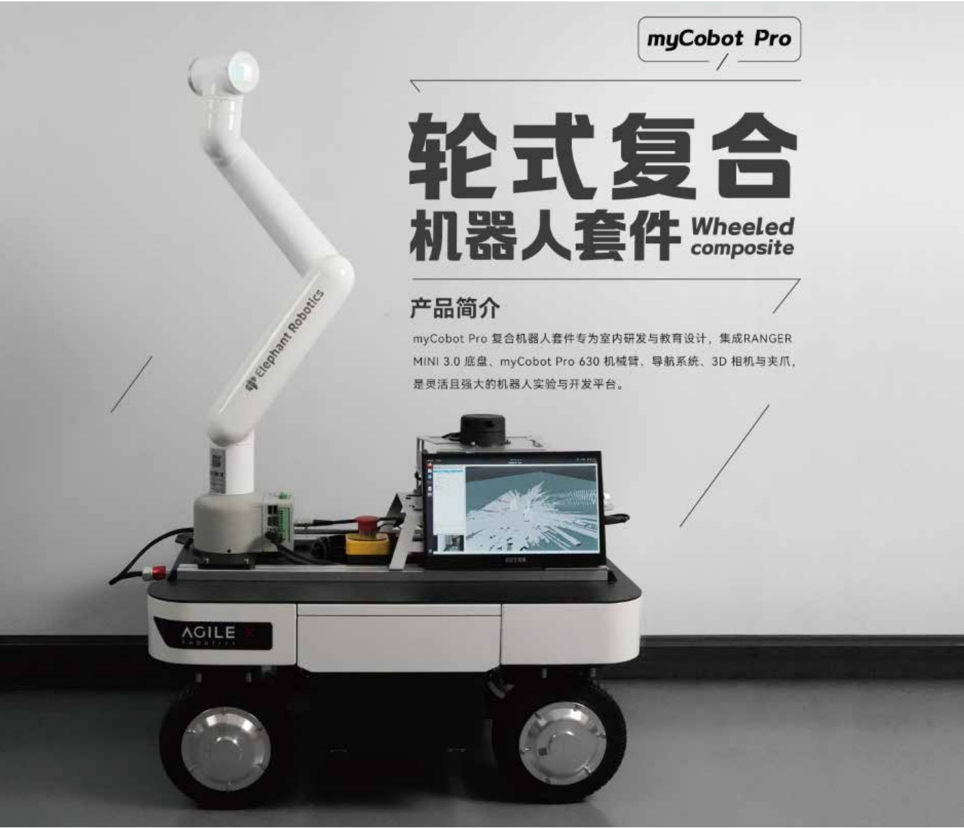
myCobot Pro 复合机器人套件专为室内研发与教育设计，集成松灵 RANGER MINI 3.0 底盘、myCobot Pro 630 机械臂、导航系统、3D 相机与夹爪，是灵活且强大的机器人实验与开发平台。具备自主导航、移动抓取等丰富应用。
