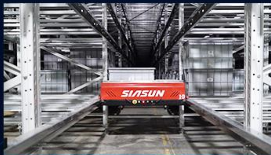
多层穿梭车满足多元化拣选和存储需求
