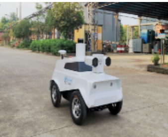
园区巡检机器人
