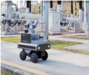
配网作业机器人
