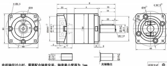
电机轴径过小时，需要配合轴套安装，轴套最小壁厚为 1mm
