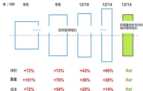
轴向叠式磁通电机定子铁芯采用**软磁粉末**压合，体积重量和成本均有不同程度的降低
