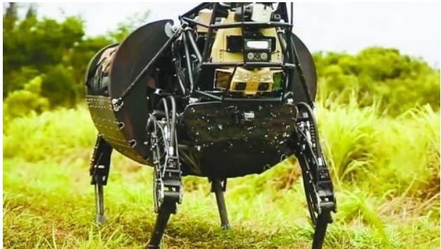
项目介绍：大型四足仿生机器人关节电机项目，最大**扭矩1200Nm**，最高输出**速度120rpm**，单电机整机**重量10kg**，目前机器人在整体路试阶段，具内部了解，该机器人为世界上第一个大型纯电动仿生机器人项目，各项性能指标世界第一，并且2020年10月通过军方所有验收指标。
