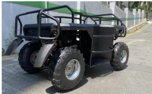
项目介绍：小型无人特种车辆，从整车外形设计、电机电控、无线遥控到加工组装等整个制造流程完全自主研发和制造，性能指标达到需方各项要求，包括30km时速、25度满载爬坡、续航50km等要求。
