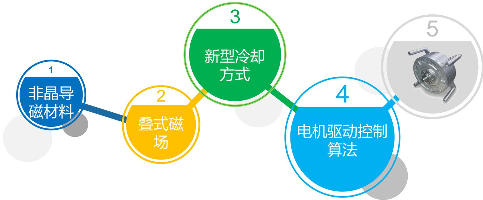
**技术路线:** 1.应用非晶压铸高磁通铁芯材料、 2.设计基于高磁通材料叠式磁场、 3.重构特种电机冷却技术、 4.集成电机驱动控制算法, 实现聚能磁高能驱动系统。
