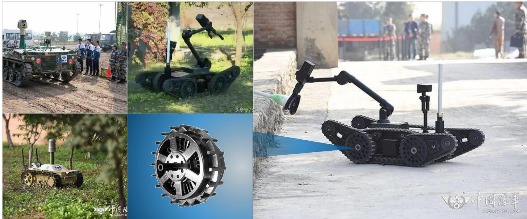
项目介绍：目前该项目性能测试已完成中科院要求，重量5kg，单个轮毂电机最大输出扭矩210Nm，最高输出速度500rpm
