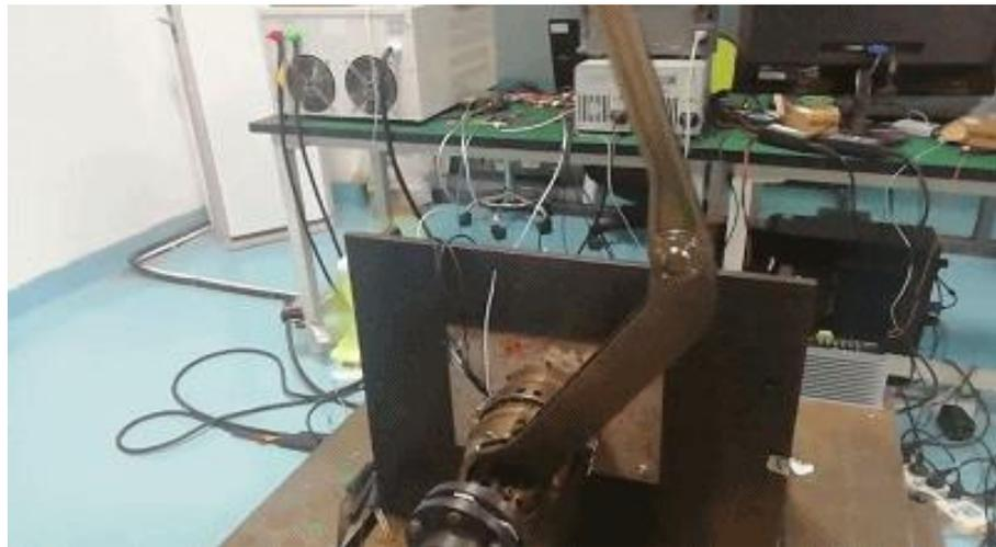
项目介绍：小型全电驱动仿生机器人项目，每条腿有3套电机动力系统，**重量2kg**单电机动力系统输出**扭矩200Nm**，最高输出速度可达**180rpm**
