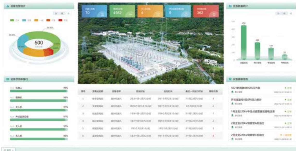
远程智能巡视系统通过巡视主机、智能分析主机，融合机器人、无人机、摄像机、声纹监测装置等数据信号，具备数据采集、自动巡视、智能分析、实时监控等功能，可实现站内设备状态全面感知、倒闸操作一键顺控、主辅智能联动等功能，可有效提升电网运维智能决策能力。
