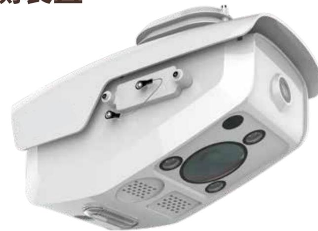
该装置是一款具有双向通道的一体化台区监测装置，装置既能对大小号双向通道做固定视角监测，也能对台区变压器、导线、金具等关键设备做细节监测并进行识别，根据识别物体情况进行趋势分析，极大提高台架变区域的巡检效率。
