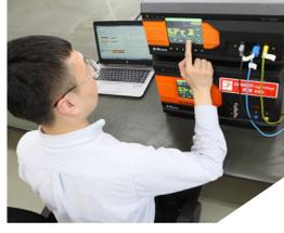
快速瞬变脉冲群抗干扰实验
