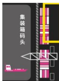
任务点中将存在 3 个集装箱，放置位置距离道路边缘 8cm，集装箱上存在数字编号，集装箱将以从左至右，从大到小的顺序在左侧排列。右侧则为集装箱放置区，智能车需去往集装箱码头，检测集装箱并将 3 个集装箱在右侧的集装箱放置区中从左至右，从小到大排列。
