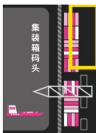
任务点中将存在 3 个集装箱，放置位置距离道路边缘 8cm，集装箱上存在数字编号，集装箱将以随机顺序在左侧排列。右侧则为集装箱放置区，智能车需去往集装箱码头，检测集装箱并将 3 个集装箱在右侧的集装箱放置区中从左至右，从小到大排列。
