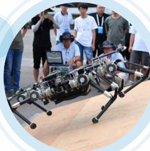
足式移动机器人穿越斜坡障碍
